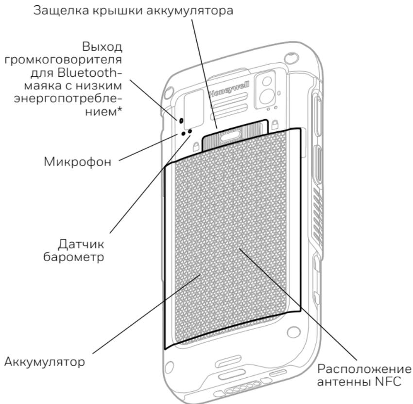
\* Входит в состав решения для поиска устройств Honeywell, когда портативный компьютер ST47 зарегистрирован в системе Operational Intelligence. Второй маячок Bluetooth с низким энергопотреблением издает сигнал, который устройство поиска может обнаружить для поиска потерянного или забытого мобильного компьютера. Динамик издаст звуковой сигнал, когда устройство находится в диапазоне, и поисковое устройство активирует звуковое уведомление.
